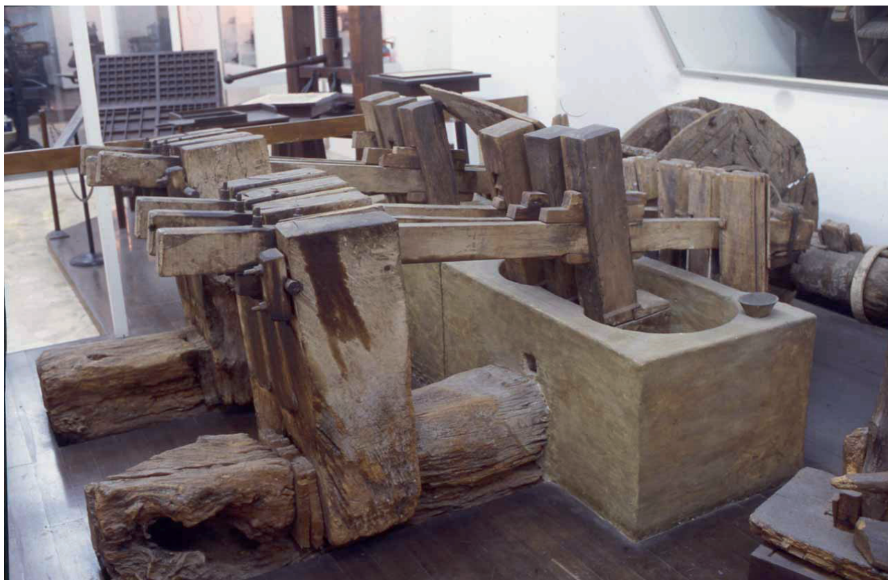
Pila idraulica a magli multipli per la triturazione in acqua di vecchi stracci per la preparazione della pasta da carta per la produzione artigianale di fogli. Fonte: Wikimedia Commons (CC BY-SA 4.0). Collezione: Museo nazionale della scienza e della tecnologia Leonardo da Vinci, Milano
