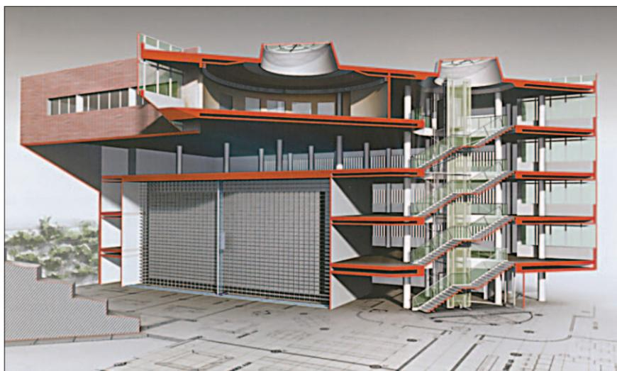
Inoltre, un sistema di passerelle in cristallo, elementi che non ostacolano la libera discesa della luce, funzionano da raccordo al resto del complesso.
