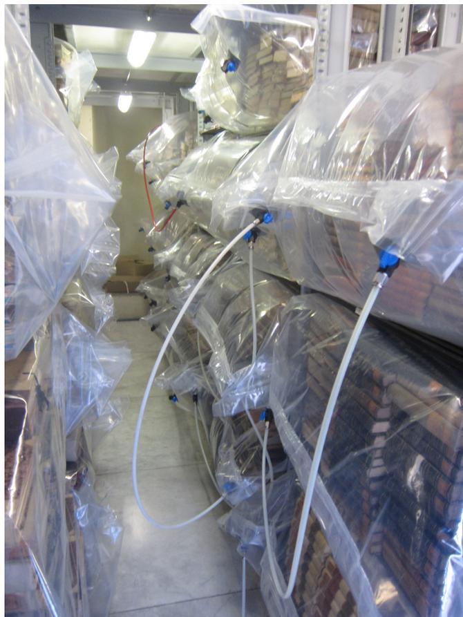
Fig. 2 - Collegamento delle buste in disinfestazione
