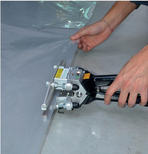
Figura 4 - La saldatura con pinza termica
