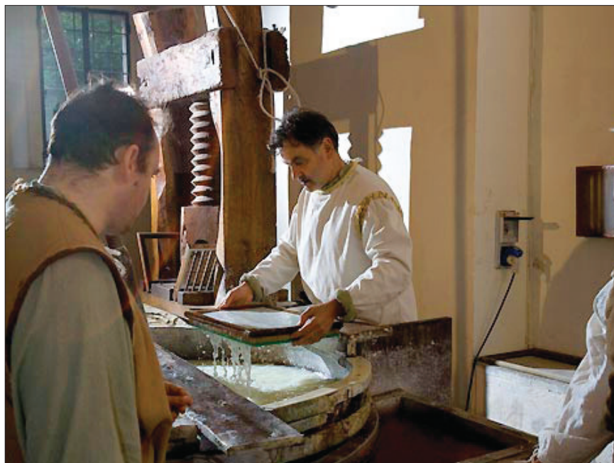
A Fabriano si effettuano ancora piccole produzioni di carta secondo la tradizione medievale: la materia prima sono ancora gli stracci (cotone, canapa, lino) e i cartai ripetono i gesti dei maestri cartai fabrianesi del XIII secolo (l'immagine è tratta dal sito web del Museo della carta e della filigrana di Fabriano: < www.museodellacarta.cpm >).
