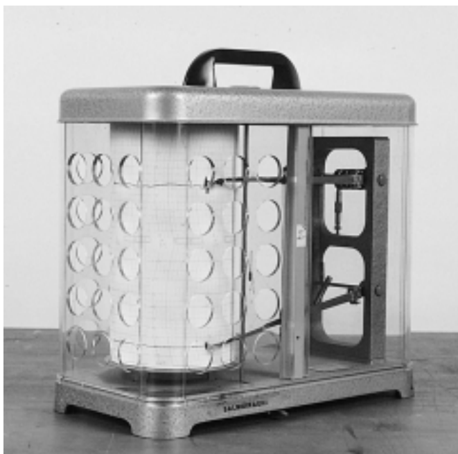
Il termoigrografo (qui sopra) registra l'andamento della temperatura e dell'umidità dell'aria
